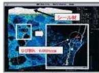
写真3 補修注入状況 (EPR/MA)
