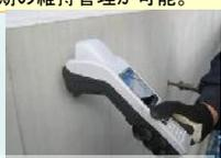
RFID腐食環境検知システム
