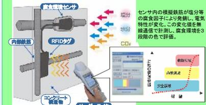
腐食環境センサ、RFIDタグ、内部鉄筋、コンクリート構造物、リーダーライタ
