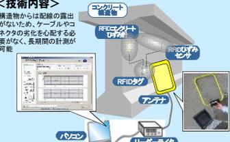
コンクリート構造物、RFIDコンクリートひずみ計、RFIDひずみセンサ、RFIDタグ、アンテナ、リーダーライタ
