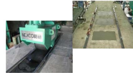
写真1 移動載荷実験
